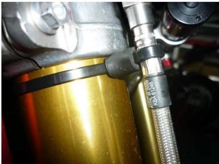
Bremsleitung kann mittels Kabelbinder und einem Stück Gummischlauch an der Gabel fixiert werden.
